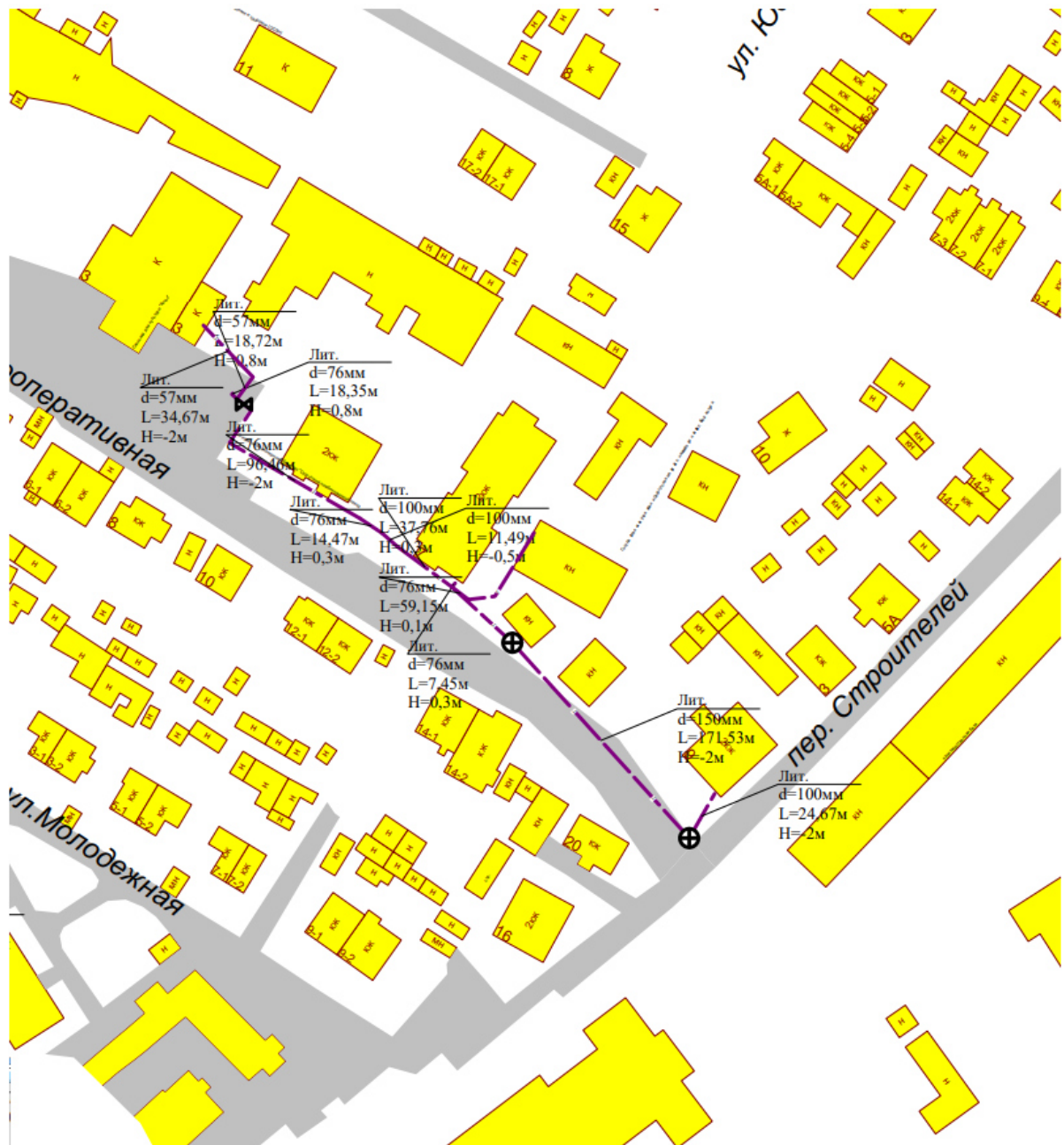
Рисунок 1.3.2.1 - Схема расположения тепловой сети котельной СДК п.
